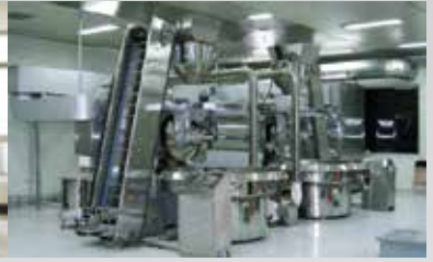
เครื่องคั่วกาแฟขนาด 60 Kg
