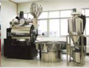
เครื่องคั่วกาแฟขนาด 60 Kg
